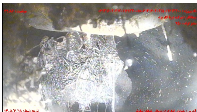
شماره تصویر ۱۱ عنوان نفوذ ریشه / نفوذ آبوه ریشه ها و کاهشی سطح مقطع به میزان ۲۰ درصد موقعیت ۲۲.۸۶ کد RM
