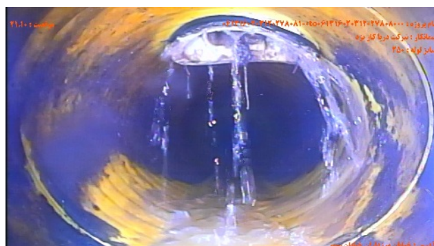
شماره تصویر ۴ عنوان اتصال جانبی معيوب / اتصال معيوب انشعاب موقعیت ۲۱۰۰ کد CX
