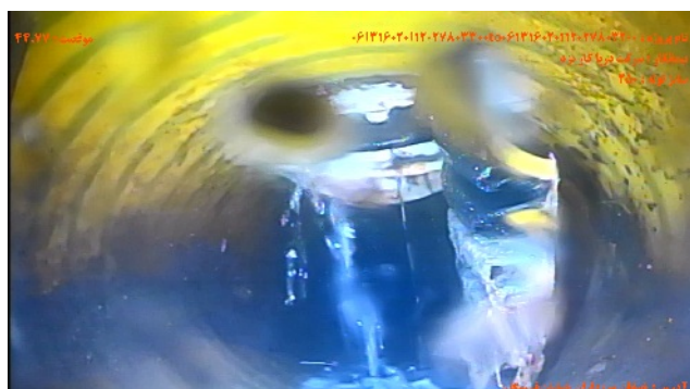
شماره تصویر ۱۵ موقعیت ۴۴.۷۷ کد CX عنوان اتصال جانبی معيوب/اتصال معيوب انشعاب
