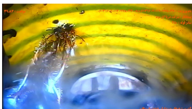
شماره تصویر ۹ عنوان نفوذ ریشه / نفوذ ریشه نازک موقعیت ۳۹.۸۳ کد RF
